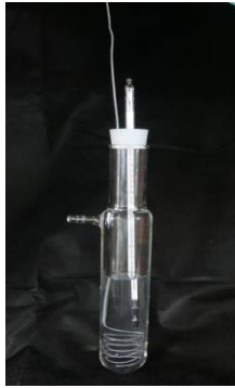
-40℃の外観 (クリアーで凍結なし) 【凍結管に試験液を入れ温度計、攪拌棒を設置した状態】
