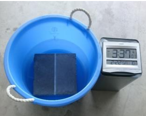
⑤ 水中養生 (2時間)
