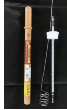
測定に用いた温度計、ケースおよび攪拌棒 ※温度計：目盛り= +2~-5.6℃
