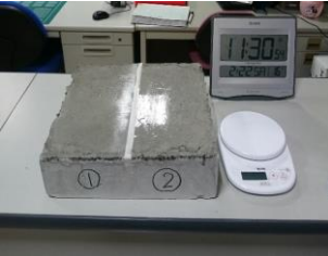
① 24時間養生のシラン系含浸材塗布 (左半分)
