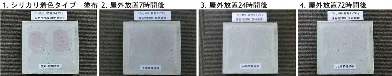
結果： シリカリの着色タイプは、コンクリートに色が付きますが、屋外では、紫外線で72時間以内に消失します。
