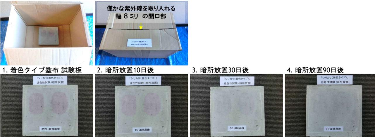
結果： シリカリの着色タイプは、コンクリートに色が付きますが、暗所では、僅かな紫外線と酸化傾向で、90日間でほぼ消失します。
