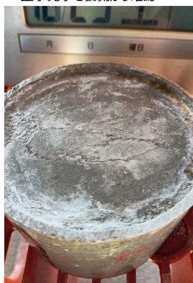
4. 凍結融解試験体の展示 ～スケーリング抑止に有効なのはどの表面含浸材？～
