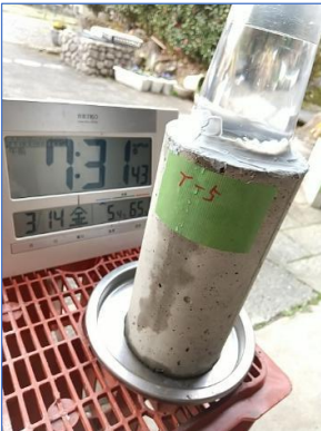
20250315 試験体漏水状況 T-⑤
