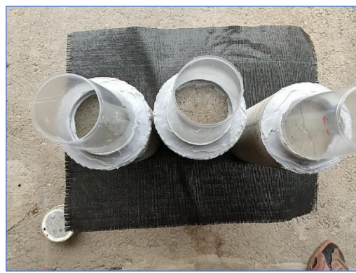
左からT-③④⑤ ③④：洗浄水が残る ⑤：乾燥状態（完全漏水）
