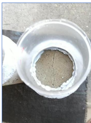
T-⑤：乾燥状態（完全漏水）
