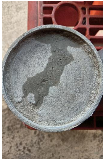
20221009ひび割れ試験体に注水(裏面)
