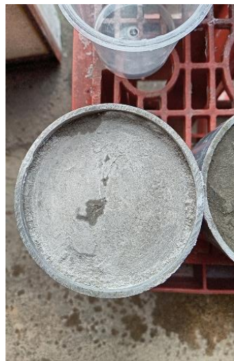
20221016ひび割れ試験体(裏面)
