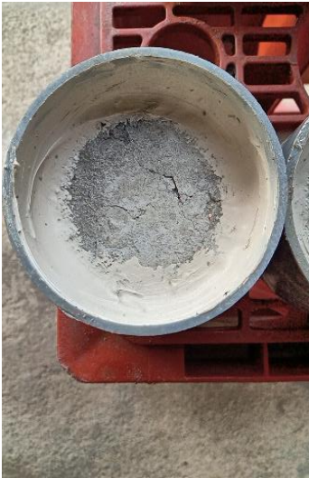
20221009ひび割れ試験体
