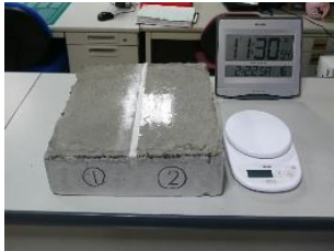
① 24時間養生のシラン系含侵材塗布（左半分）
