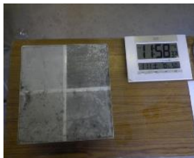
① RC平板に含侵材塗布
