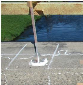
写真3 透水器具の設置状況
