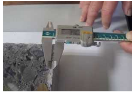
WATER SHIELDの含浸深さ測定状況（3か所平均値 3.38mm）
