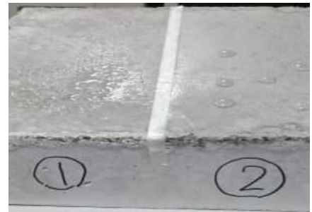
塗布2時間後の撥水状況(①は一般的なシラン系表面含浸材、②はWATER SHIELD)
