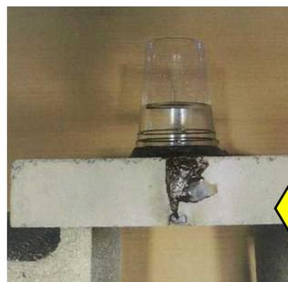
コンクリート平板にはひび割れが入っています。シリカリ塗布後、コップに水を入れていますが、漏れ落ちません。
