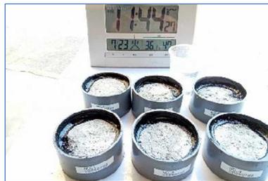
試験体に注水、漏水状況を確認
